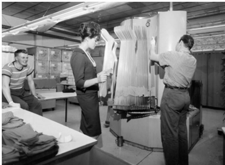
Muotoilu kuului saumatun ohutsukan valmistusvaiheisiin. Kuva Ke-riin tehtaalta vuodelta 1962.
